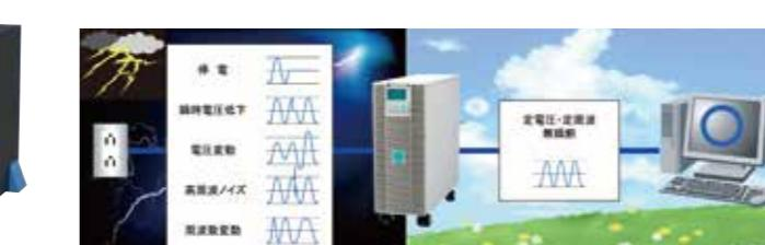
■無停電電源装置(UPS)は、予期せぬ停電だけでなく、電圧変動、電源ノイズ、発電機を併用したときの周波数変動等、ほとんどの電源障害から重要なシステムを守ります。
