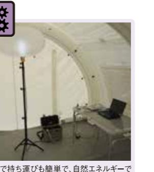
1人で持ち運びも簡単で、自然エネルギーで電源確保を行うことが可能です。特に屋内の電源使用においては、従来の発電機のように燃料供給や、排ガスの問題を気にせず使用することができます。
